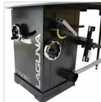
Commande de l'inclinaison et de la hauteur de coupe
