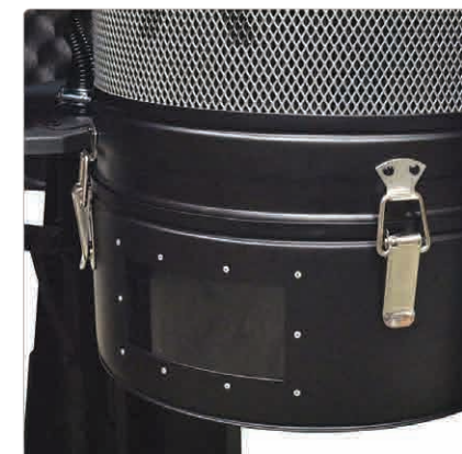
Contrôle de colmatage du bac de collecte
